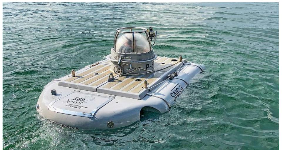
Le submersible de 5,50 mètres de long est propulsé par quatre moteurs électriques. —SUBSPIRIT
